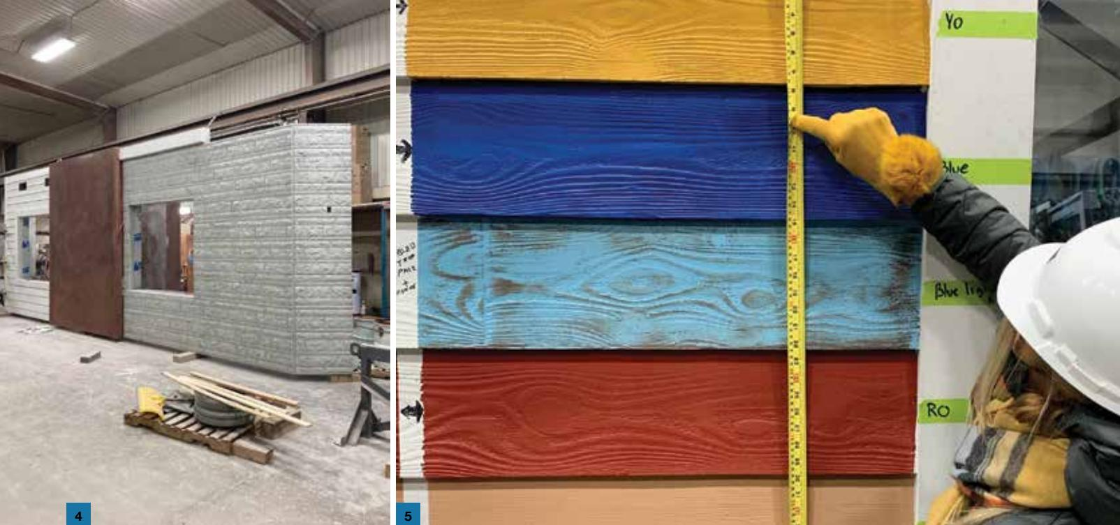
4. An exterior precast concrete wall section in the plant showing the various siding types achieved with formliners. / Une section de panneau de mur extérieur de béton préfabriqué lors de sa fabrication en usine montrant les différents types de finis réalisés à l'aide des matrices de coffrage.
