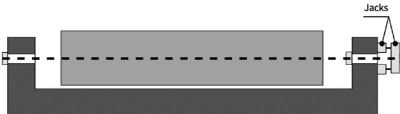
B. Concrete is poured into the formwork and cured. / Le béton est coulé dans le coffrage et durcit.
